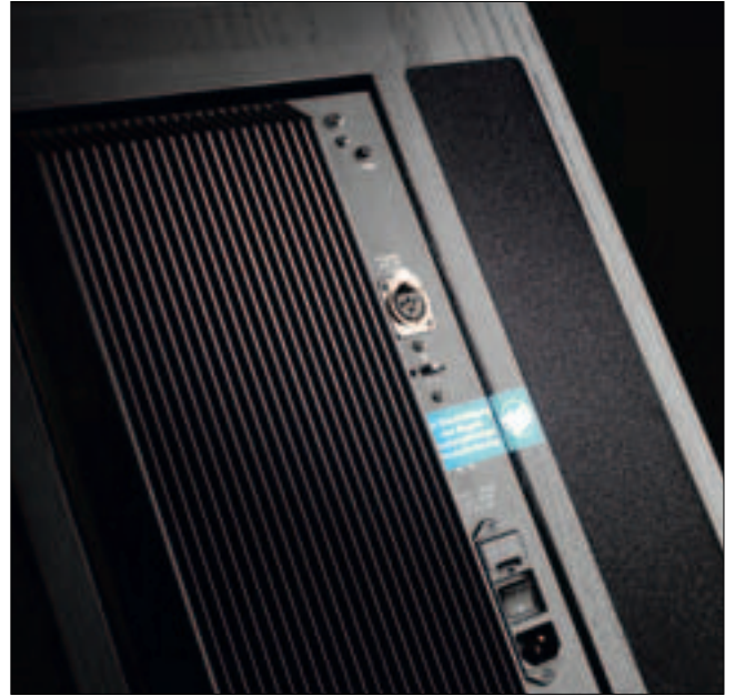
Leistungsgesellschaft: Der Verstärkerblock des RL 901 K vereinigt drei Endstufen mit zusammen rund 400 Watt Nennleistung.
